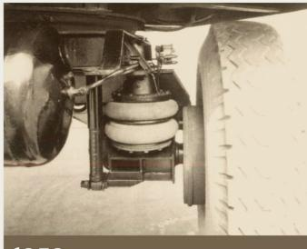
BPW首次推出一款挂车用分层式气囊空气悬架车轴,开创了空气悬 架应用于货物运输的先河。
