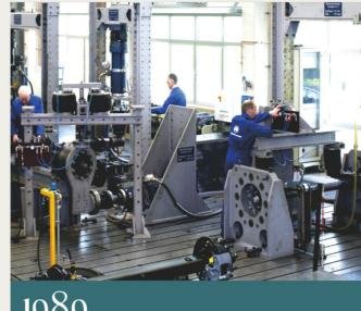
建立了BPW布鲁彻姆试验中心,模拟车辆运行时车轴的各种负载 和制动状况进行试验,便于研发提高产品质量。
